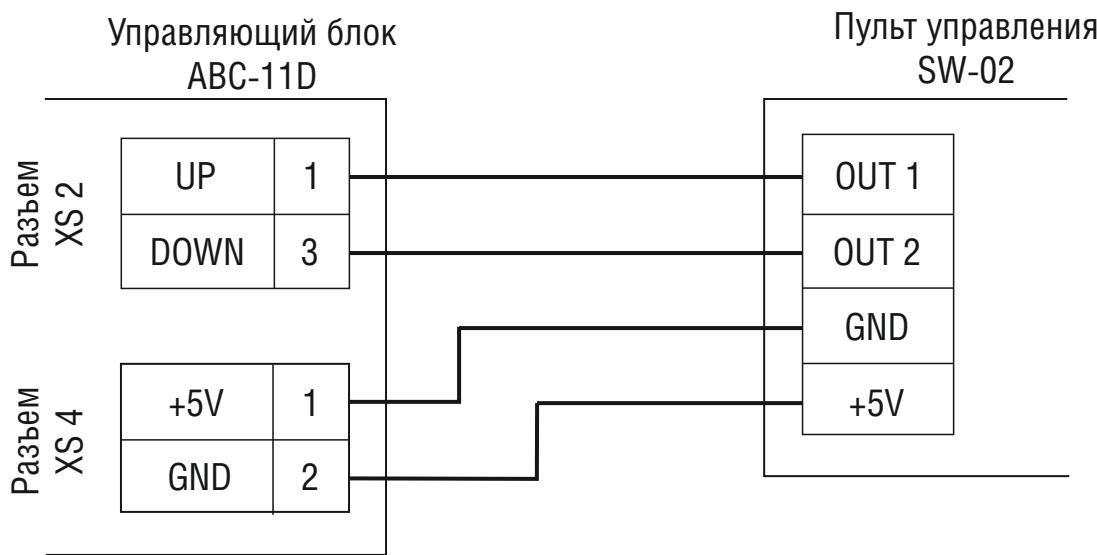
Рисунок 6.8.2 Схема подключения пульта дистанционного управления шлагбаумом «SW-02»
