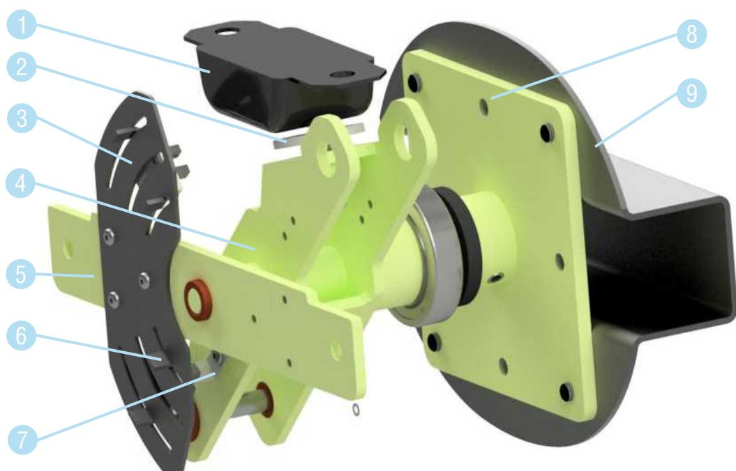
Рисунок 6.2.1 Узел крепления и управления стрелой
