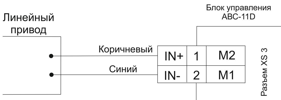
Схема подключения модуля положения стрелы к управляющему блоку
